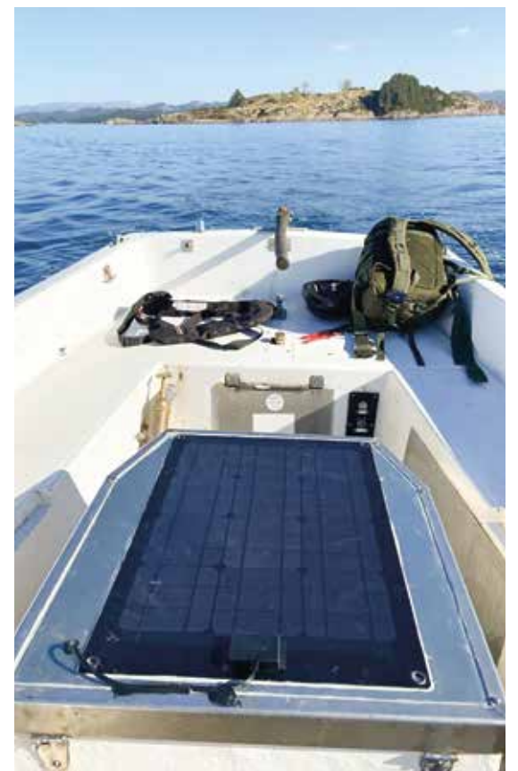
Solcellepanel på motorkassen til Marøyferjå. Foto Erik Thoring
